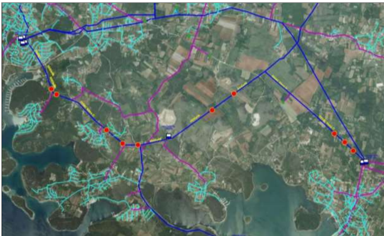
Slika 1.1.2-1. Mjesta pucanja magistralnog cjevovoda
